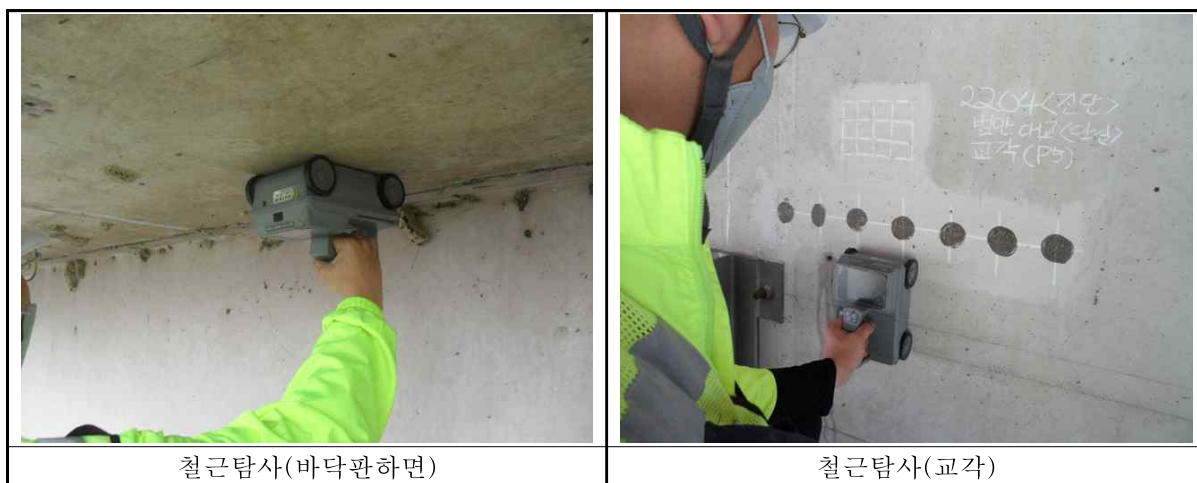
<그림 3.15> 철근탐사 시험
