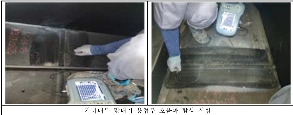
<그림 3.20> 초음파 탐상(사각법) 시험
