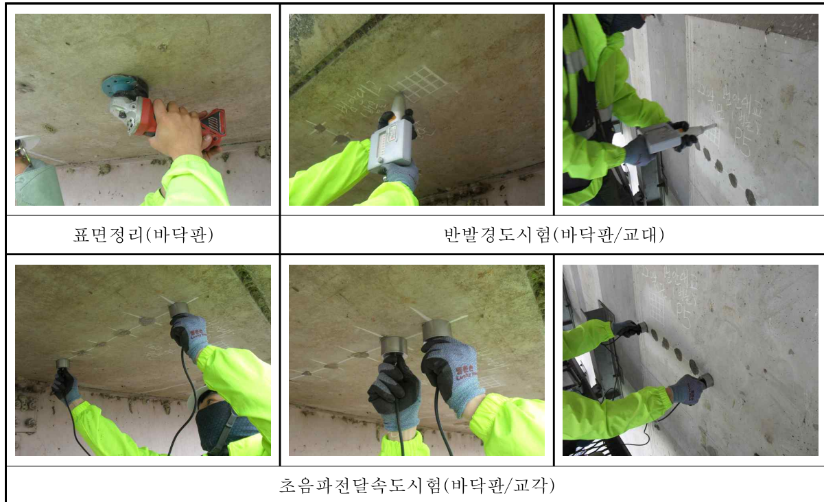
<그림 3.7> 콘크리트 강도조사
